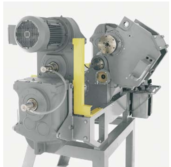
Die Schwingenkonstruktion kommt dem Walzenwechsel beim Produkt- oder Chargenwechsel und der Wartung sehr entgegen.
