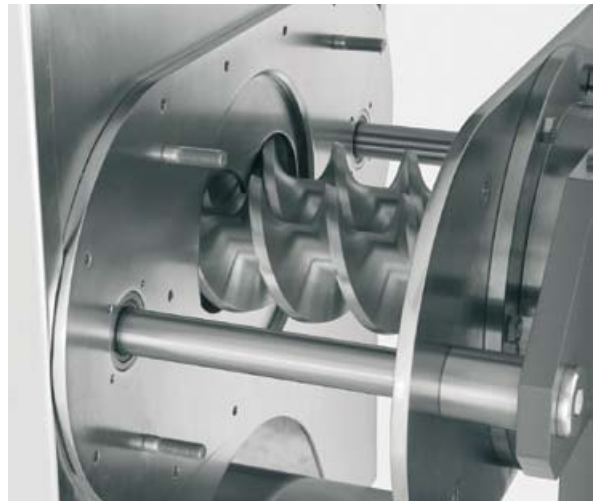
Im Design des PP 250 spiegelt sich die jahrzehntelange Erfahrung im Bau von Walzenpressen: alle Module sind leicht zugänglich. Das Bild zeigt das Ausfahren der speisenden Schnecken (ohne Spezialwerkzeug).
