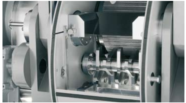
Direkt im Walzenspalt angeordnet: der Schülpenbrecher.
