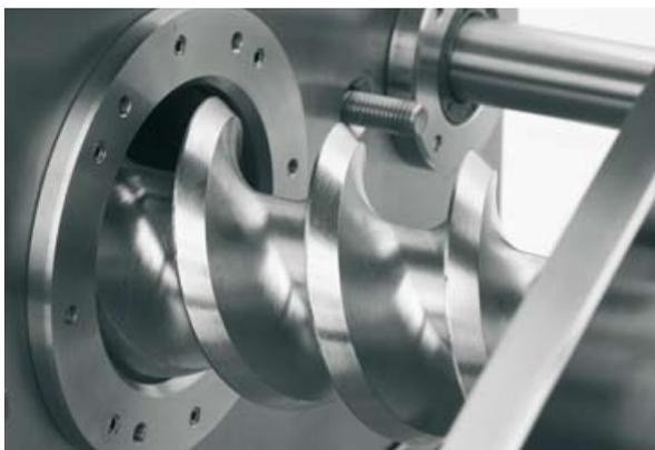
Alexanderwerk verfügt über eine jahrzehntelange Erfahrung im Bau von Walzenpressen, die sich in der PP-Serie widerspiegelt: alle Module des PP 175 sind leicht zugänglich. Das Bild zeigt das Ausfahren der speisenden Schnecke (ohne Spezialwerkzeug).
