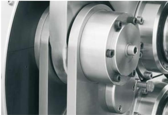
Steuer- und Regeltechnik in Verbindung mit zwei Hydraulikzylindern sorgen für den konstanten Walzenspalt und damit die Güte der Schülpe.
